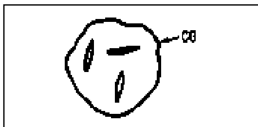
Figura 20- Ferrita de Segunda fase não alinhada
