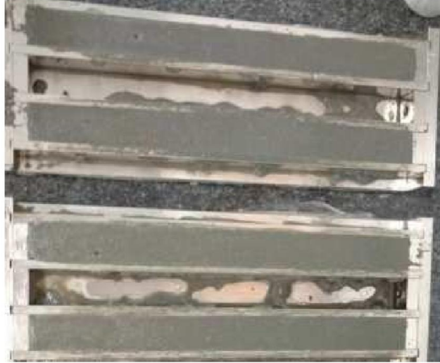
Figura 19 - Corpos de prova para ensaio de retração
