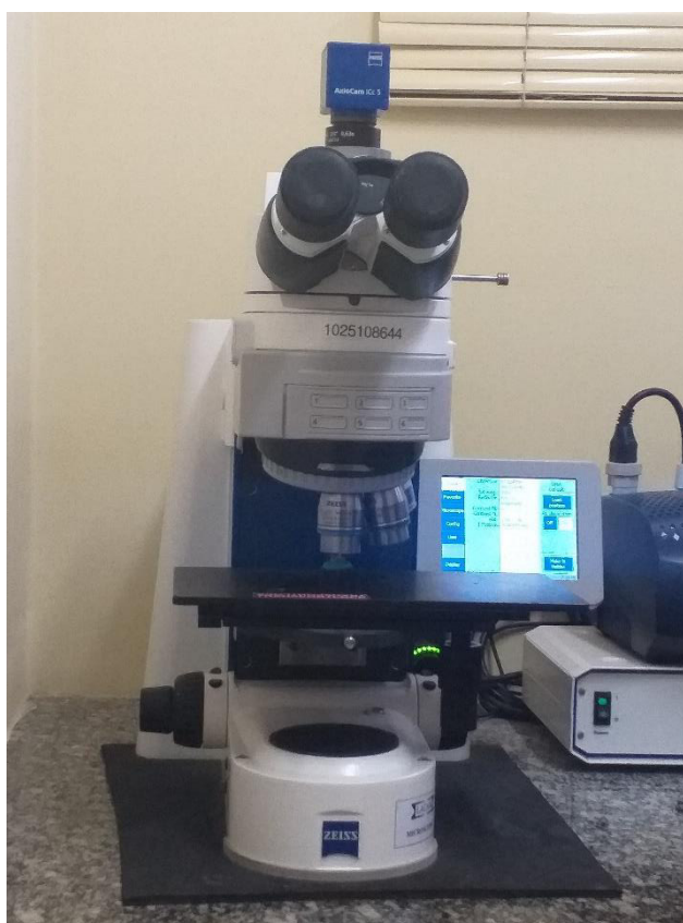
Figura 18 – Microscópio ótico Axio Imager.M2m da Zeiss utilizado na etapa de Metalografia.
