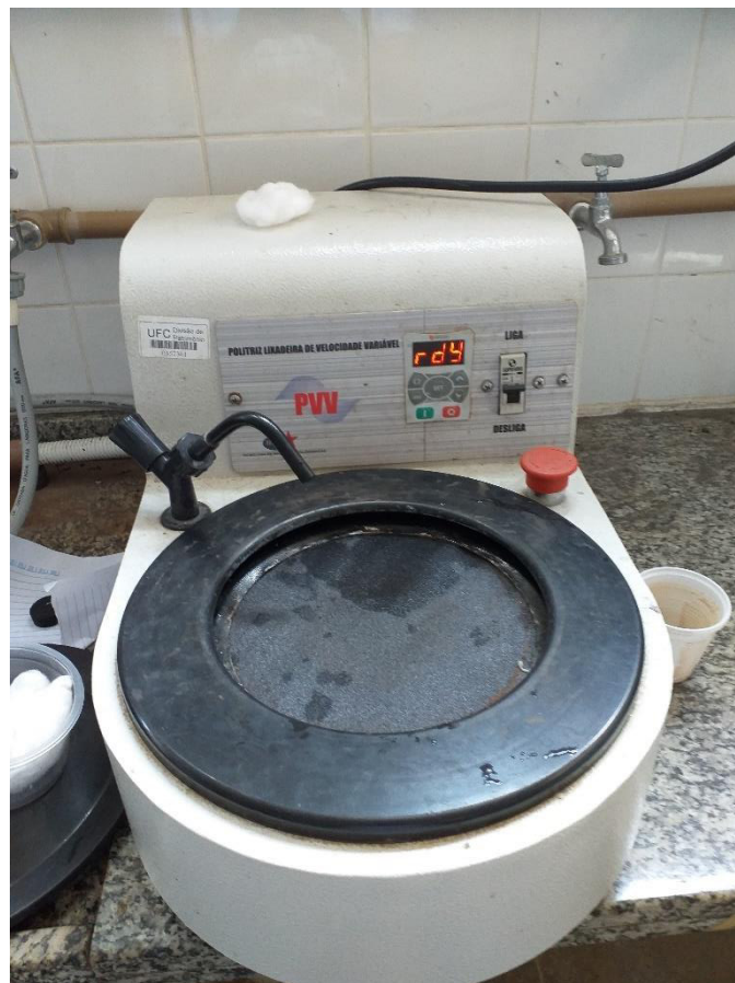
Figura 17 – Politriz pvv utilizada na etapa de Metalografia.
