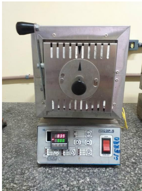
Figura 14 – Forno EDG 3P-S utilizado na etapa de tratamento isotérmico.
