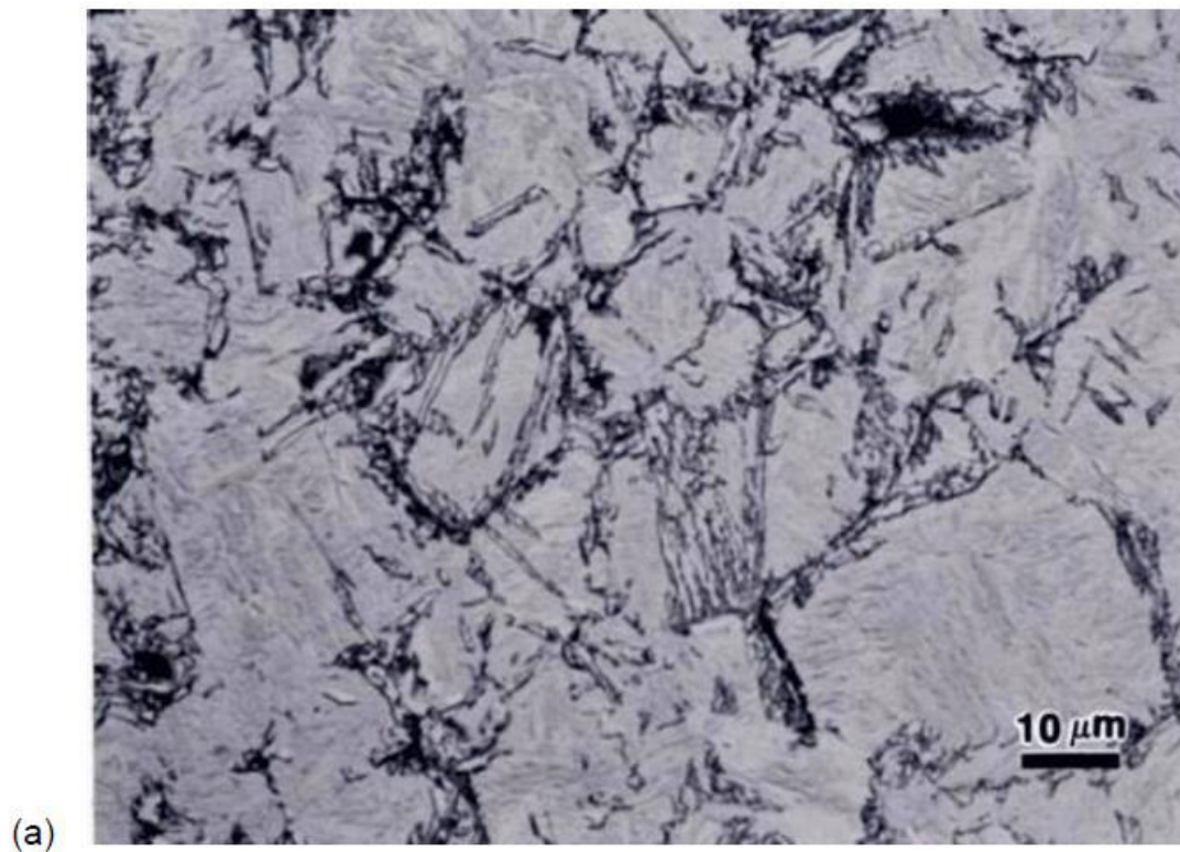
Figura 4 – Microestrutura de um aço 5160 austenitizado em 830°C, tratado isotermicamente e temperado em água, para dois tratamentos isotérmicos diferentes: (a) bainita superior sobre fundo de martensita, gerada em 538°C por 60s; (b) bainita inferior sobre fundo de martensita, gerada em 343°C por 5 minutos. Ataque: nital 2%.
