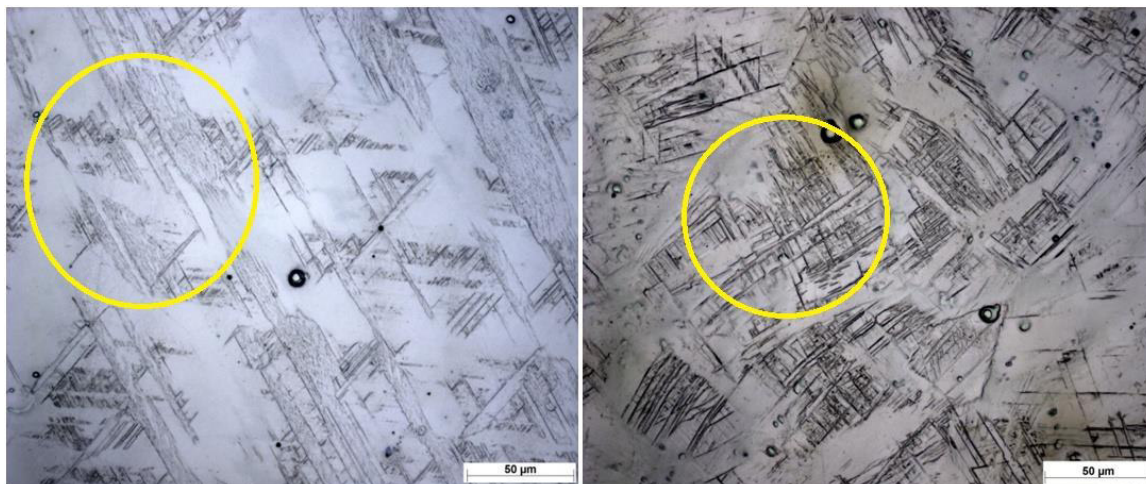
Figura 12 - Microestruturas das amostras (a) como recebida; (b) 20M; Aumento x500. Ataque Químico: Nital 2%.
