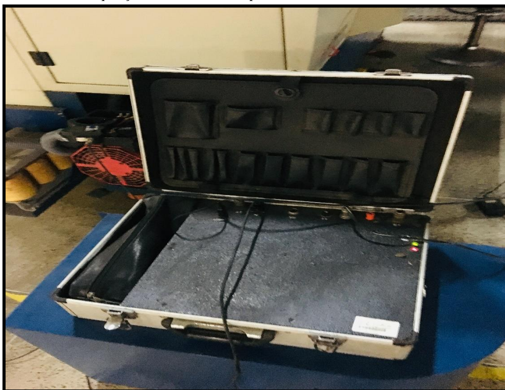
Figura 4.2: Sistema de aquisição de dados utilizada para monitoramento da corrente
