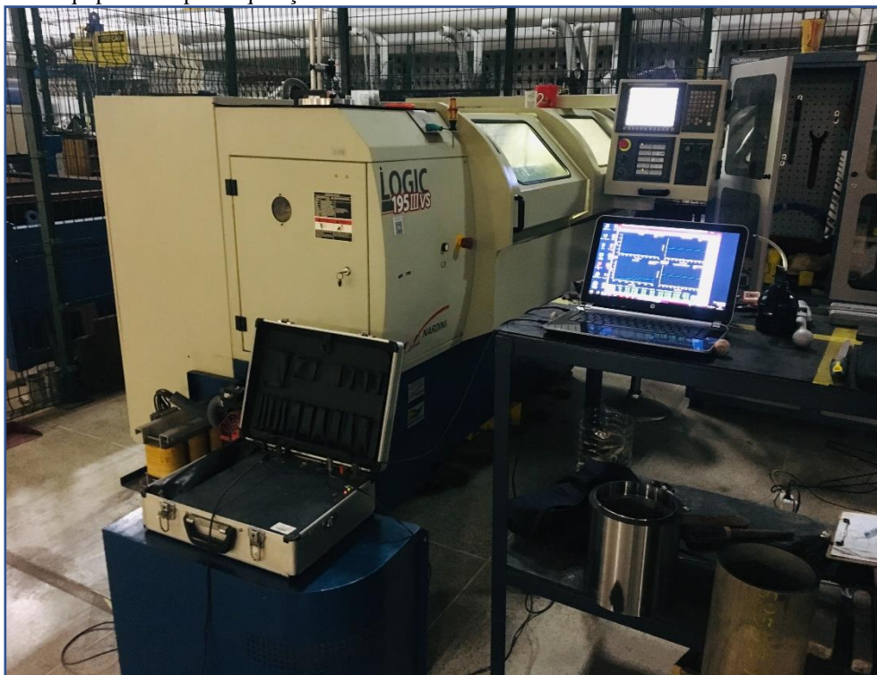
Figura 4.7: Equipamento para aquisição do sinal de corrente instalado no torno CNC.
