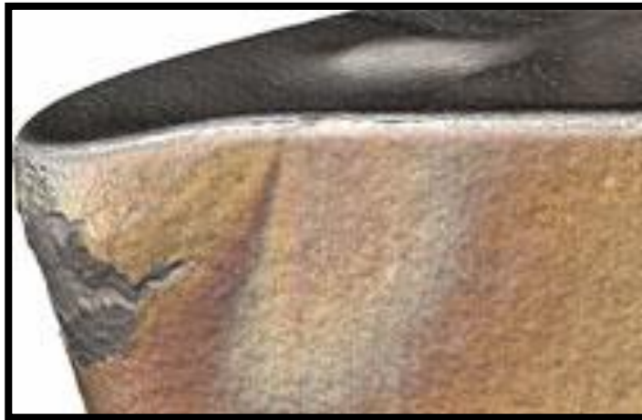
Figura 3.7: Deformação plástica da aresta de corte
