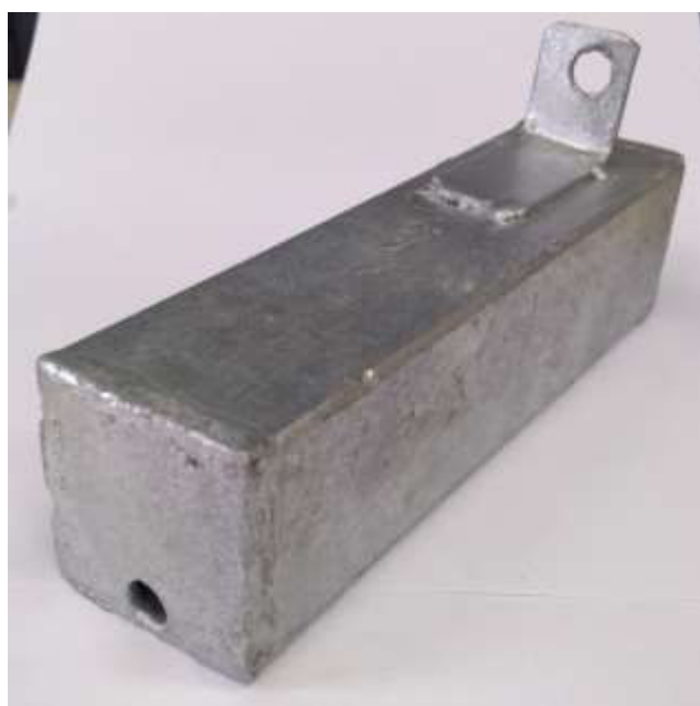
Figura 13 – Amostra de tubo metalon com furos para drenagem e ventilação
