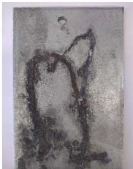
Figura 16 - Amostra de chapa de aço apresentando regiões sem revestimento de zinco fundido
