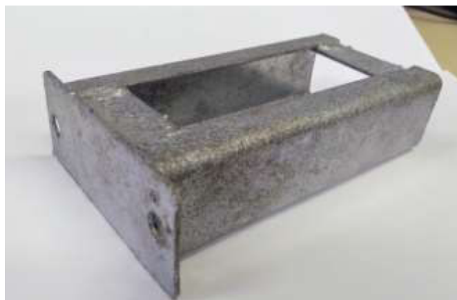
Figura 19 - Amostra de perfil enrijecido de aço carbono 75 X 40 X 10mm, sem furos de ventilação
