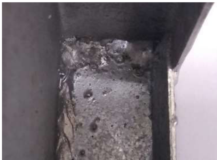
Figura 23 - Amostra de perfil estrutural enrijecido de aço carbono 75 X 40 X 10mm, com furos de ventilação e apresentando alta qualidade no produto final galvanizado
