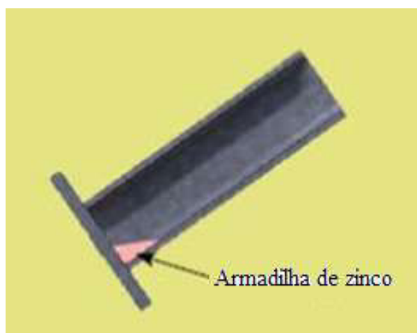
Figura 21 – Armadilha de zinco na estrutura a ser galvanizada [adaptado de 17]
