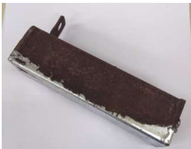
Figura 11– Amostra de tubo metálico com regiões sem revestimento de zinco fundido
