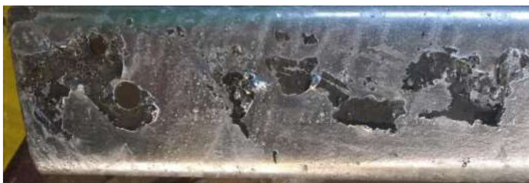
Figura 17 – Amostra perfil estrutural enrijecido 90 X 60 X 10mm com regiões sem revestimento de zinco fundido
