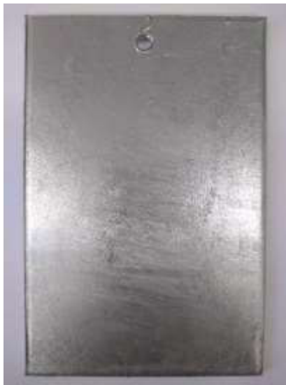
Figura 18 – Amostra de chapa de aço com alta qualidade no revestimento de zinco fundido
