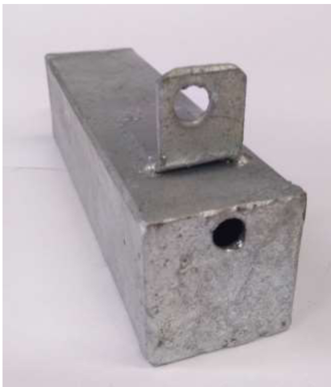
Figura 14 - Amostra de tubo metalon com furos para drenagem e ventilação
