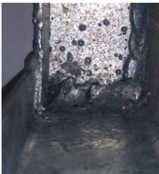
Figura 20 - Amostra de perfil estrutural enrijecido de aço carbono 75 X 40 X 10mm, sem furos de ventilação, apresentando manchas e pequenos pontos de acúmulo de cinzas
