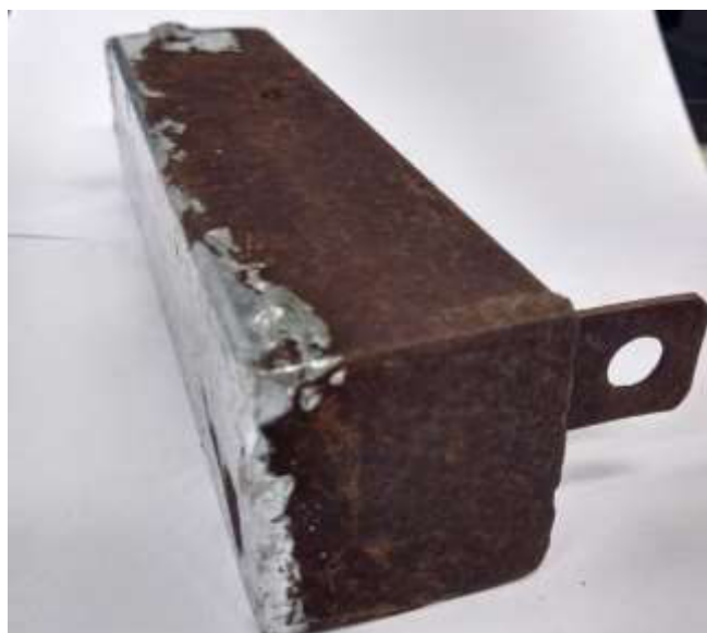
Figura 12 - Amostra de tubo metálico com regiões sem revestimento de zinco fundido
