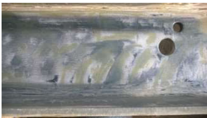
Figura 15 - Amostra perfil estrutural enrijecido 90 X 60 X 10mm com regiões revestidas de tinta epóxi
