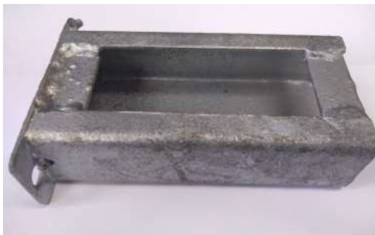
Figura 22 - Amostra de perfil estrutural enrijecido de aço carbono 75 X 40 X 10mm, com furos de ventilação
