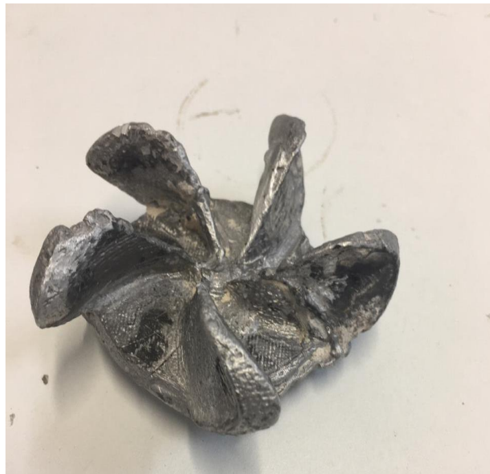
Figura 22- Peça após a solidificação e a retirada da casca refratária.
