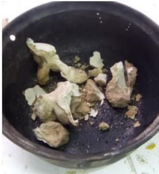
Figura 17- Primeira casca cerâmica a 200°C.
