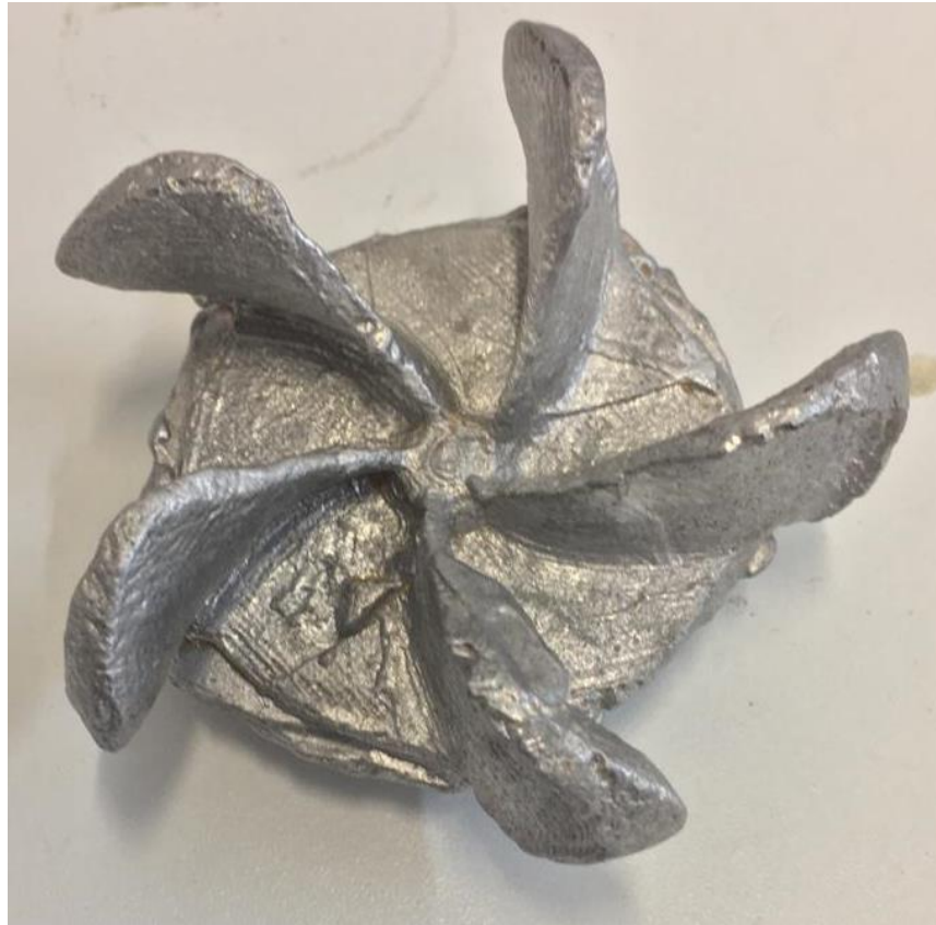
Figura 24- Peça após a limpeza da casca e o corte do massalote.
