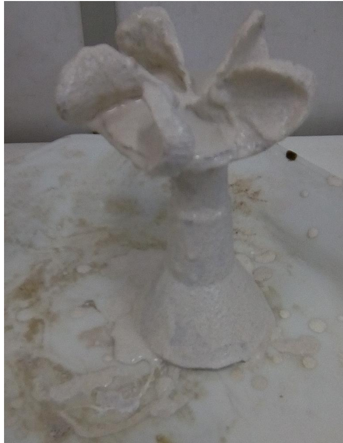
Figura 15- Peça coberta com duas camadas de refratário.
