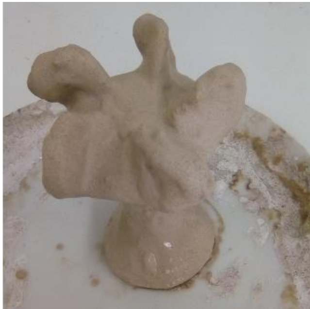
Figura 16- Peça com cinco camadas pronta para a retirada da cera.
