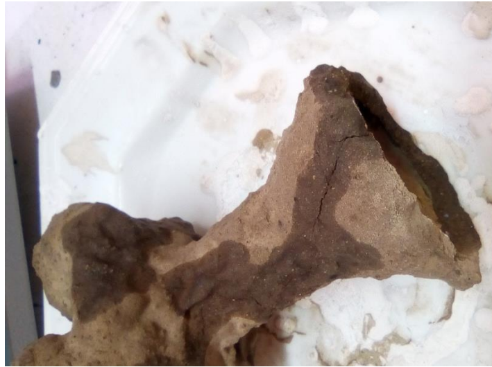
Figura 18 Casca cerâmica após a retirada da cera.
