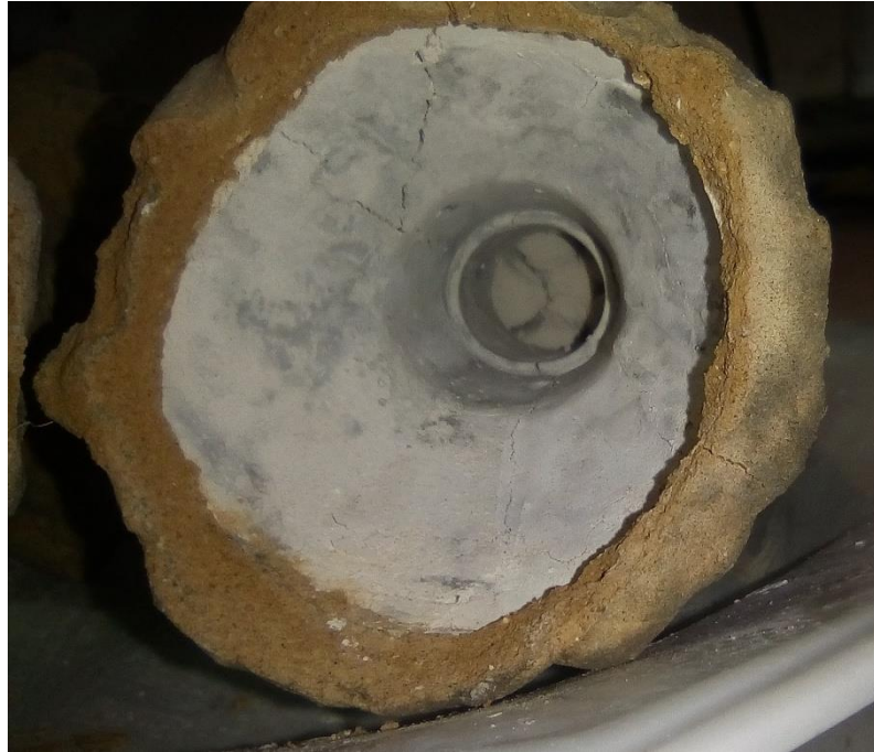
Figura 20- Terceira casca cerâmica após a calcinação a 750 °C.
