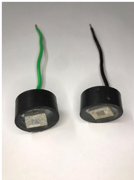
Figura 2. Eletrodos de trabalho, à esquerda amostra de magnésio puro e à direita amostra de liga de magnésio com terras raras.
