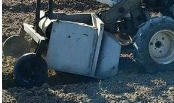
Figura 11 – Encanteirador acoplado ao microtrator
