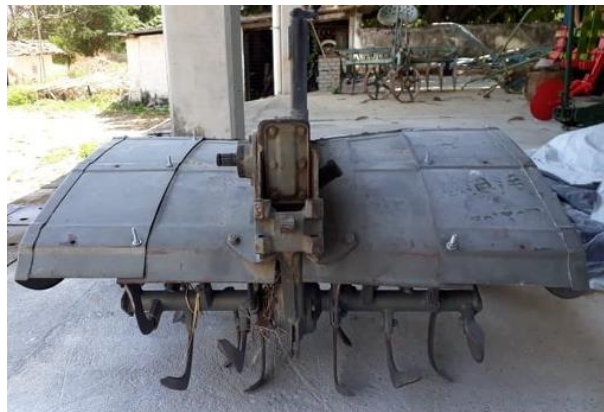
Figura 10 – Enxada rotativa com facas tipo L
