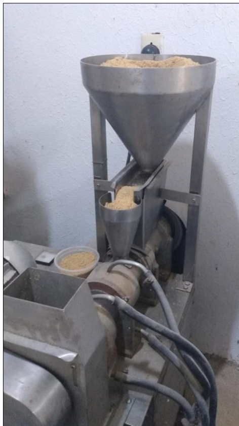
Figura 4 – Processo de extrusão dos ingredientes para a fabricação da ração com base em farinha de larva de mosca, Hermetia illucens
