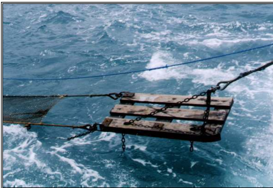
FIGURA 14 – Porta ligada as tralhas superior e inferior e pé de galinha ao cabo de arrasto
