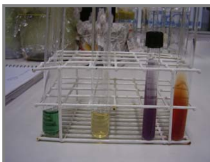
Figura 2.12 - Tubos de ensaio contendo os meios Malonato, SIM, LIA e TSI antes de serem inoculados com as amostras de Tagelus plebeius .
