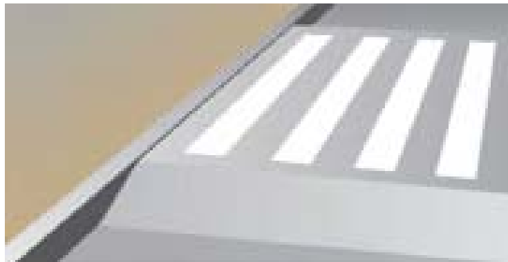
Figura 6.4: Travessia elevada (DENATRAN, 2000).
