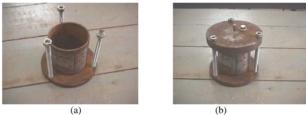
Figura 4.3 – Molde de aço para injeção de resina (a) aberto (b) fechado
