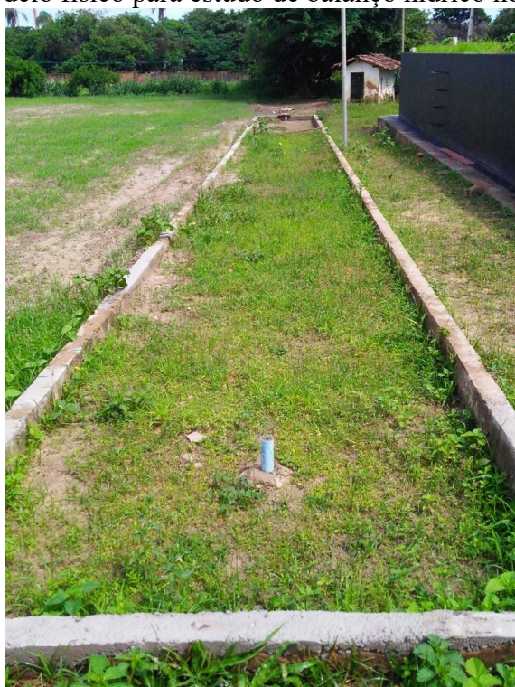
Figura 2 – Modelo físico para estudo de balanço hídrico no solo.
