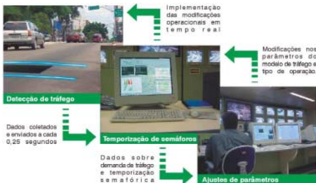
**Figura 5.3:** Fluxograma do processo de otimização semafórica do sistema SCOOT no CTAFOR
