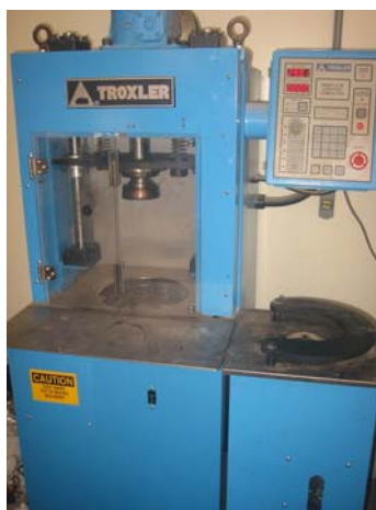
Figura 4.11: Compactador giratório LMP/DET/UFC - Troxler 4140
