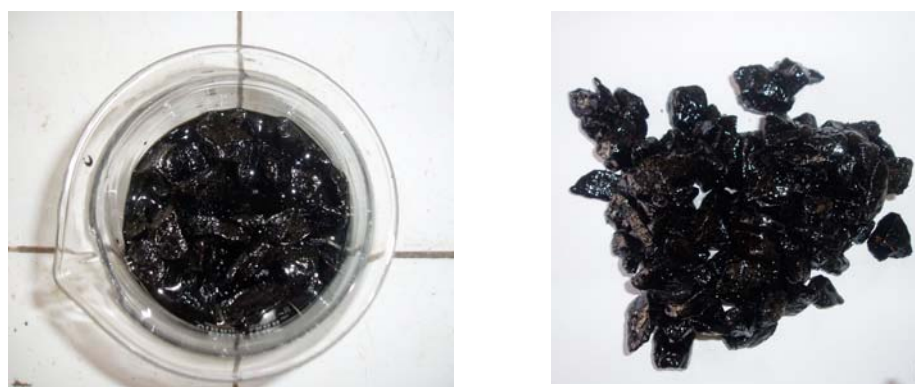
Figura 3.2: Etapas do ensaio de adesividade realizado para a brita \frac{3}{4} "
