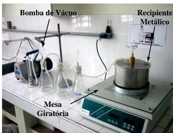
Figura 2.12: Equipamento de aplicação de vácuo para retirada do ar nos vazios da mistura (VASCONCELOS et al. , 2003)
