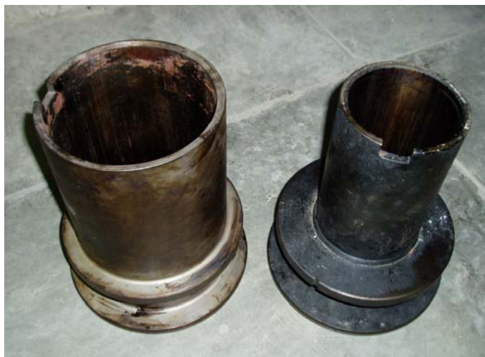
Figura 2.8: Moldes cilíndricos de 150 e 100mm de diâmetro
