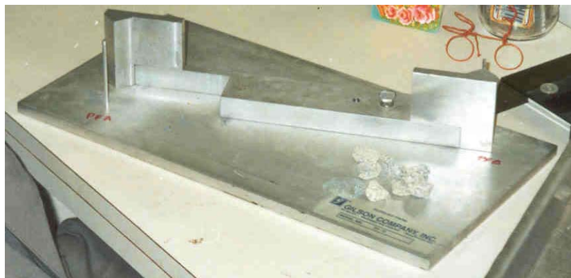
Figura 3.4: Paquímetro para determinação da lamelaridade de agregado graúdo
