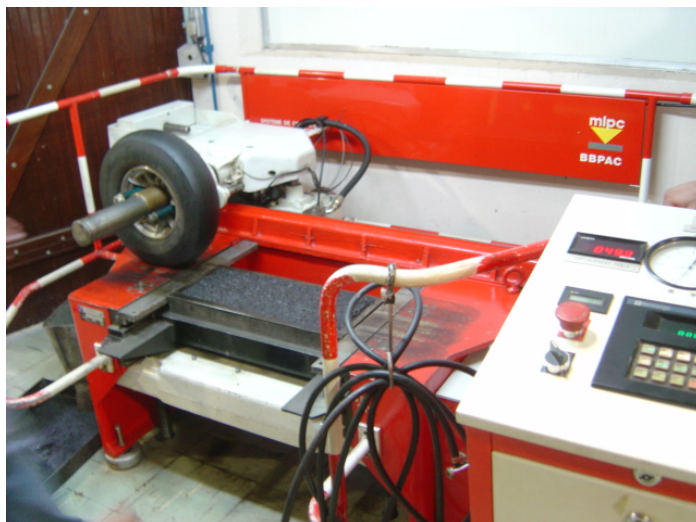
Figura 5.16: Mesa compactadora tipo LPC (LTP/EPUSP)
