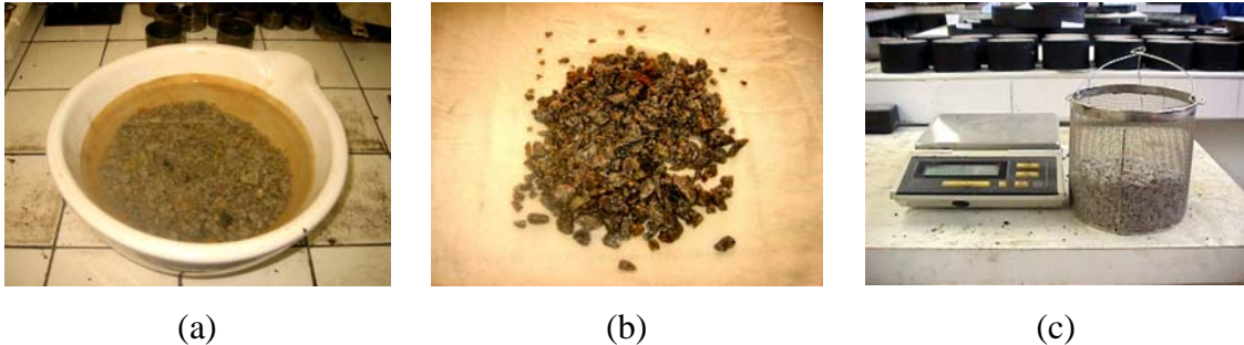
Figura 3.3: Alguns passos do ensaio de densidade de agregado graúdo (Fonte: VASCONCELOS e SOARES, 2003)
