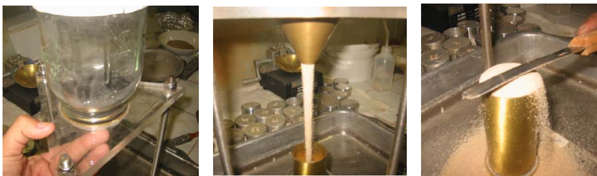
Figura 3.7: Algumas etapas do ensaio de angularidade de agregado miúdo
