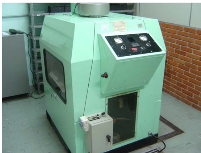
Figura 5.17: Simulador de tráfego tipo LPC (LTP/EPUSP)
