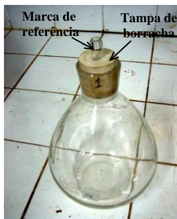
Figura 2.11: Ilustração da tampa de borracha com orifício preenchido com vidro de diâmetro reduzido (VASCONCELOS et al. , 2003)
