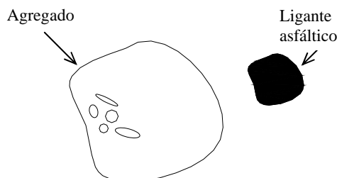
Figura 2.10: Ilustração do volume considerado na determinação da densidade real de agregados e ligante asfáltico
