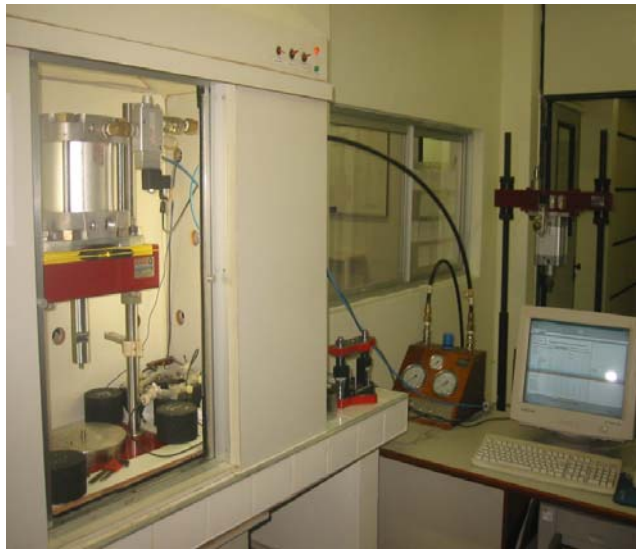
Figura 5.5: Equipamento de carga repetida LMP/DET/UFC
