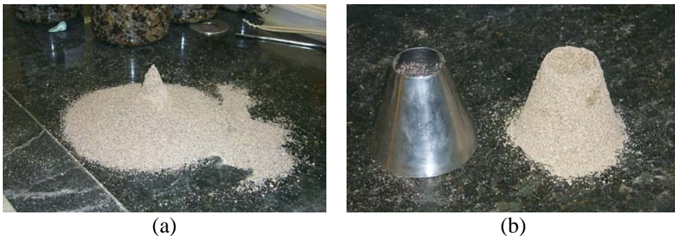
Figura 3.5: Passos para determinação da densidade de agregado miúdo (ASTM C 128): (a) material muito seco; (b) deslizamento ótimo da amostra
