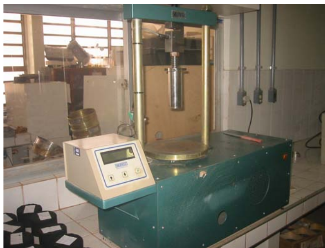
Figura 5.2: Prensa mecânica utilizada para realização dos ensaios de resistência à tração
