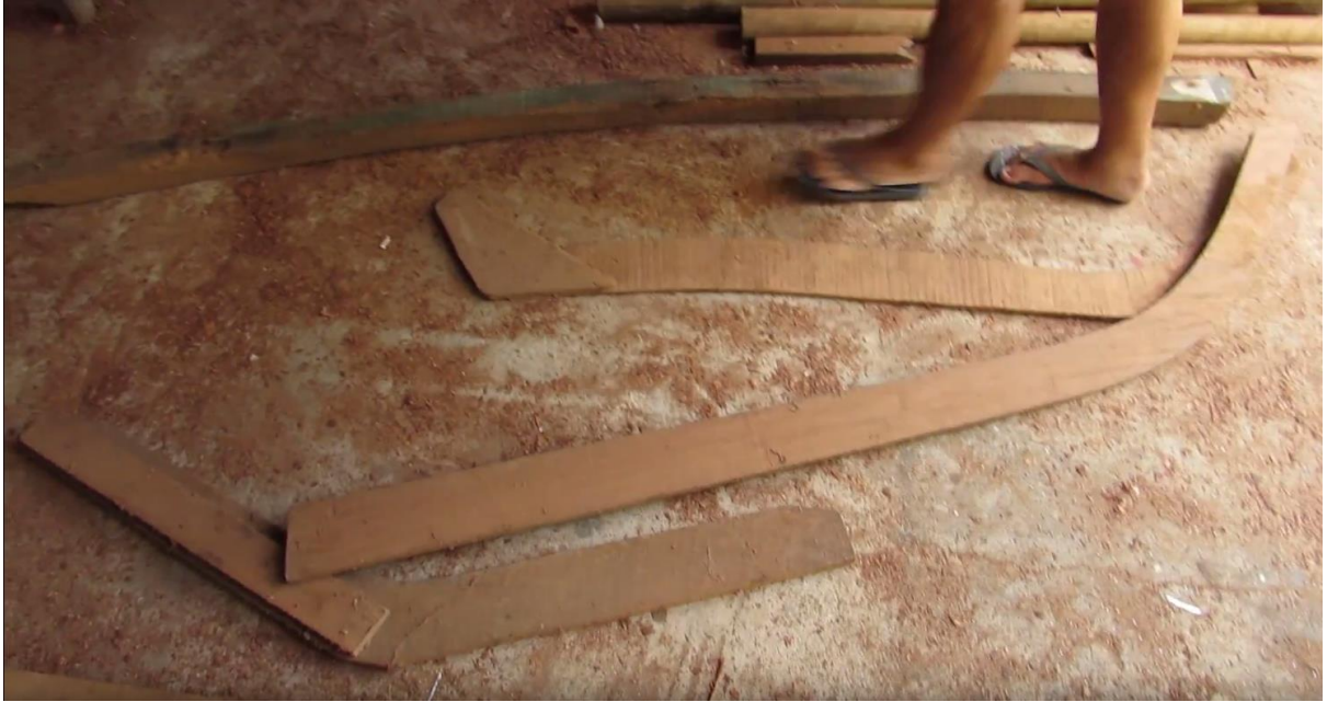
Figura 11 – De cima para baixo: fôrma para desenho da latra, do Espelho de Popa, da Caverna mestra e de ângulo para a Caverna Mestra
