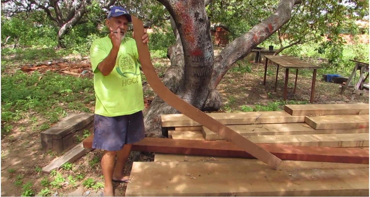
Figura 13 – Fôrma utilizada para o desenho da Caverna Mestra
