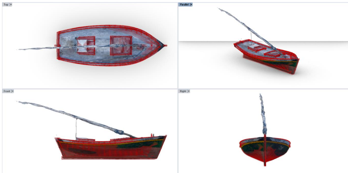
Figura 16 – Algoritmo do bote sob modelo gerado por fotogrametria em interface do Rhinoceros 3D.
