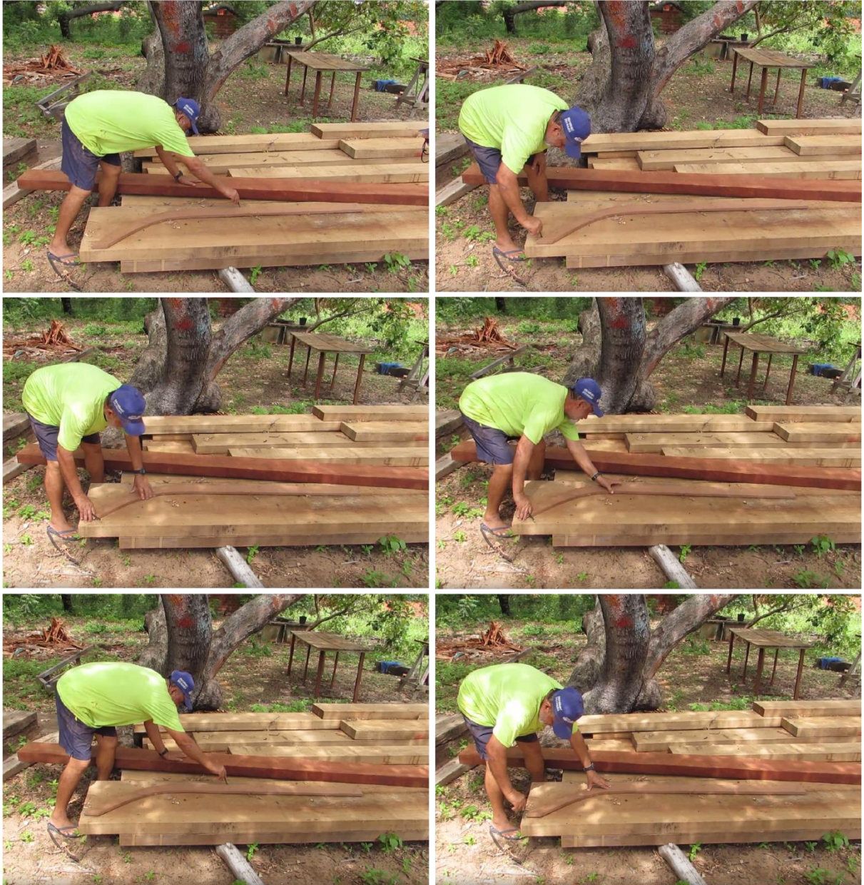
Figura 15 – Carpinteiro Nivaldo fazendo demonstração do traçado da Caverna Mestra a partir da fôrma, com diferentes curvaturas.
