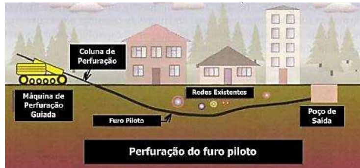
Figura 7 - Perfuração do furo piloto
