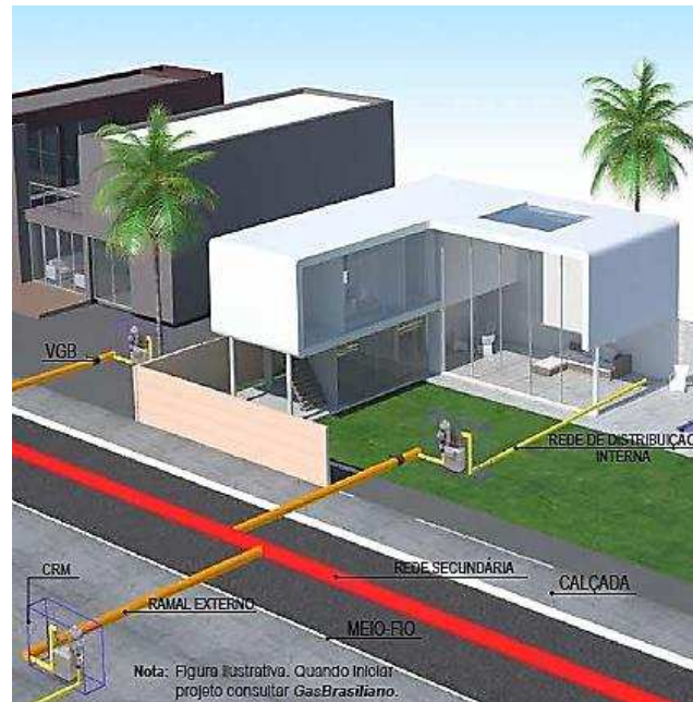
Figura 5 - Ilustração de rede de distribuição secundária
