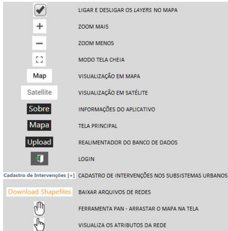
Figura 33 - Ferramentas da aplicação GEOINFRA
