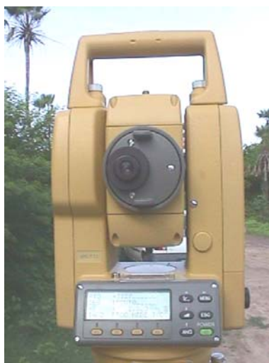
Figura 5.15: Estação Total Utilizada na Pesquisa
