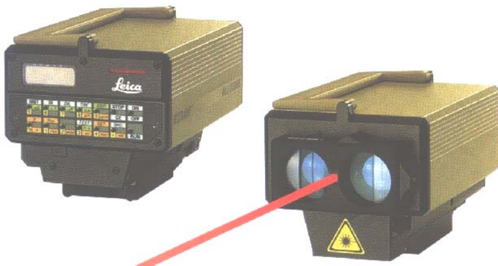
Figura 5.13: Exemplo de um Distanciômetro Eletrônico
