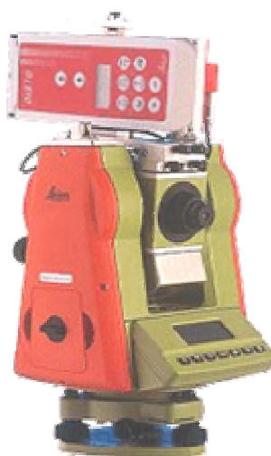
Figura 5.12: Exemplo de um Teodolito Eletrônico com uma Trena Eletrônica Acoplada
