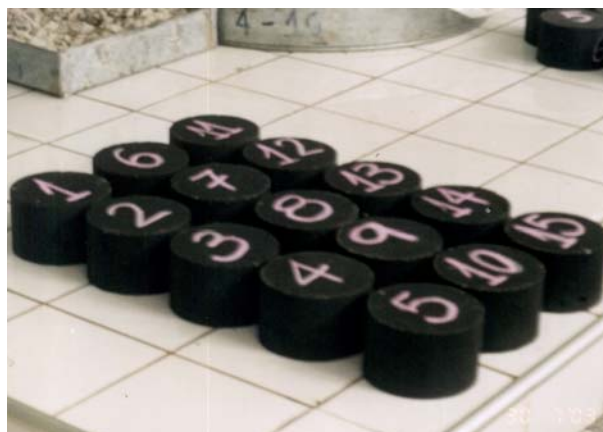
Figura 4.1: Corpos de prova moldados para a definição do teor de projeto
