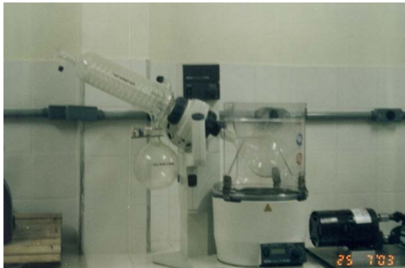
Figura 2.10: Aparelho de extração e recuperação de asfalto.
