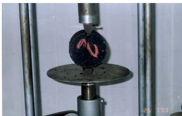
Figura 4.4: Detalhe de uma amostra rompida no ensaio de RT
