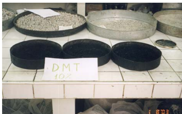
Figura 4.3: Mistura preparada para a determinação da DMT
