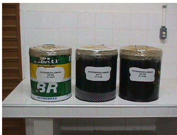
Figura 3.13: Amostra produzida na LUBNOR dos ARs 75, 250, 500
