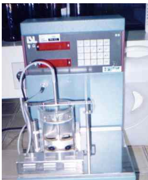
Figura 2.14: Ensaio para determinação do ponto de amolecimento (anel e bola)
