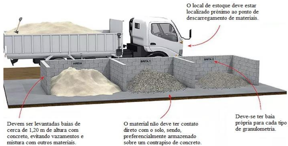
Figura 35 - Esquema de armazenamento de agregados em obra.
