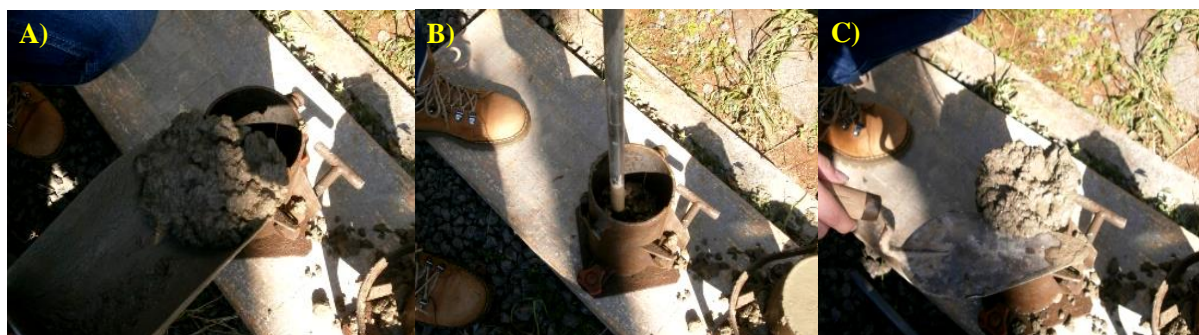
Figura 49 - Moldagem de corpos de prova. A) Preenchimento em camadas B) Adensamento C) Arrasamento do corpo de prova
