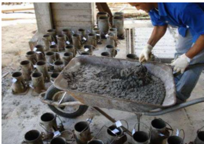
Figura 14 - Moldagem de corpos de prova cilíndricos.
