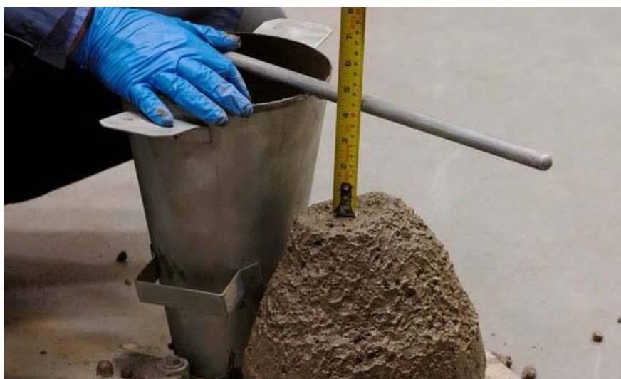
Figura 48 - Medição do abatimento do concreto com auxílio de trena
