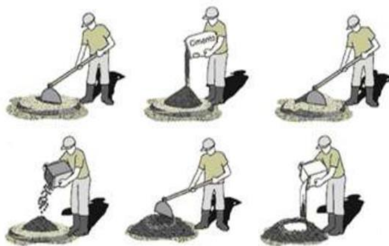
Figura 8 - Mistura manual do concreto
