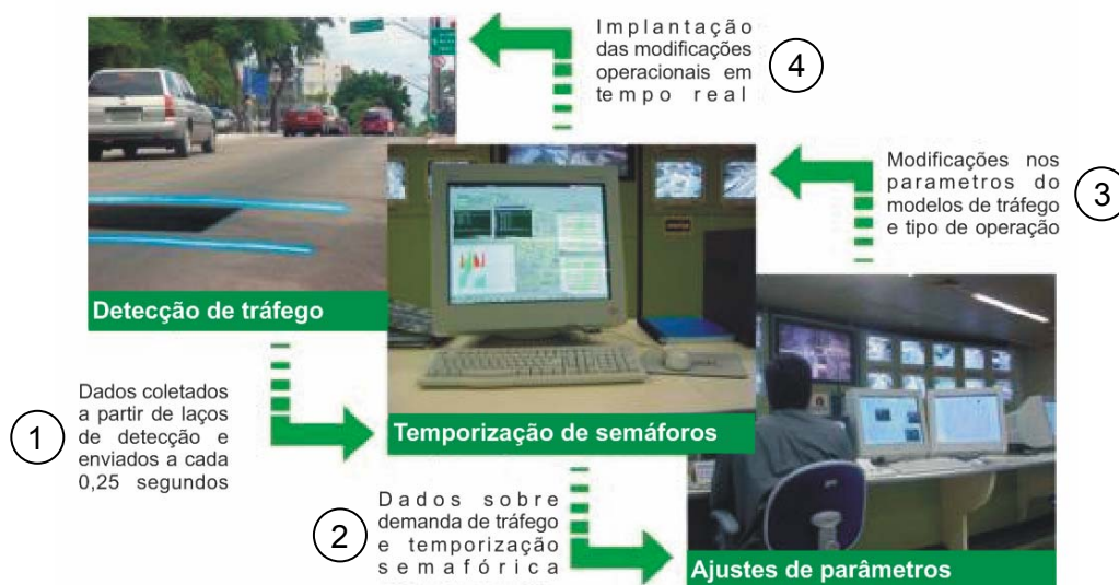
Figura 3.1: Esquema de funcionamento do sistema SCOOT
