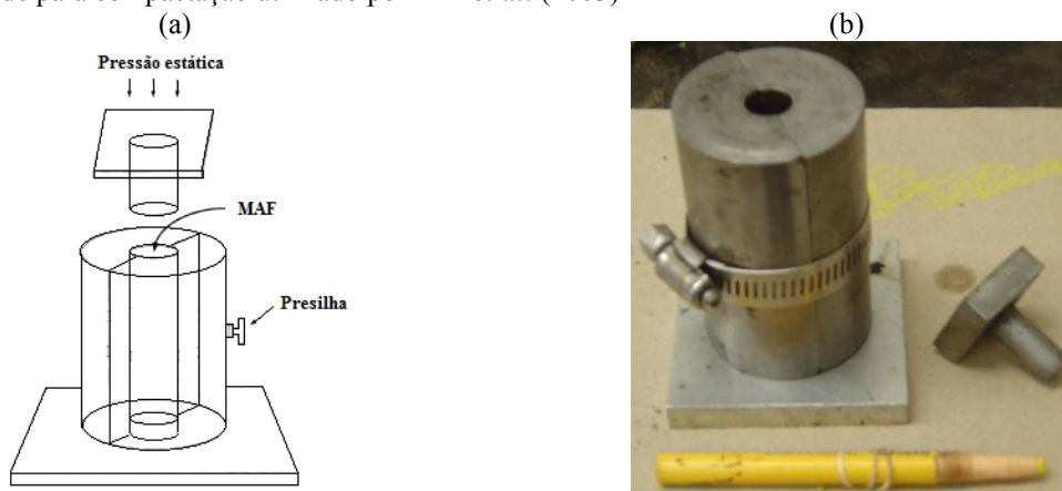
Figura 2.4 – (a) Esquema representativo do molde para compactação das amostras de MAFs (adaptado de Kim et al. , 2003) (b) Molde para compactação utilizado por Kim et al. (2003)
