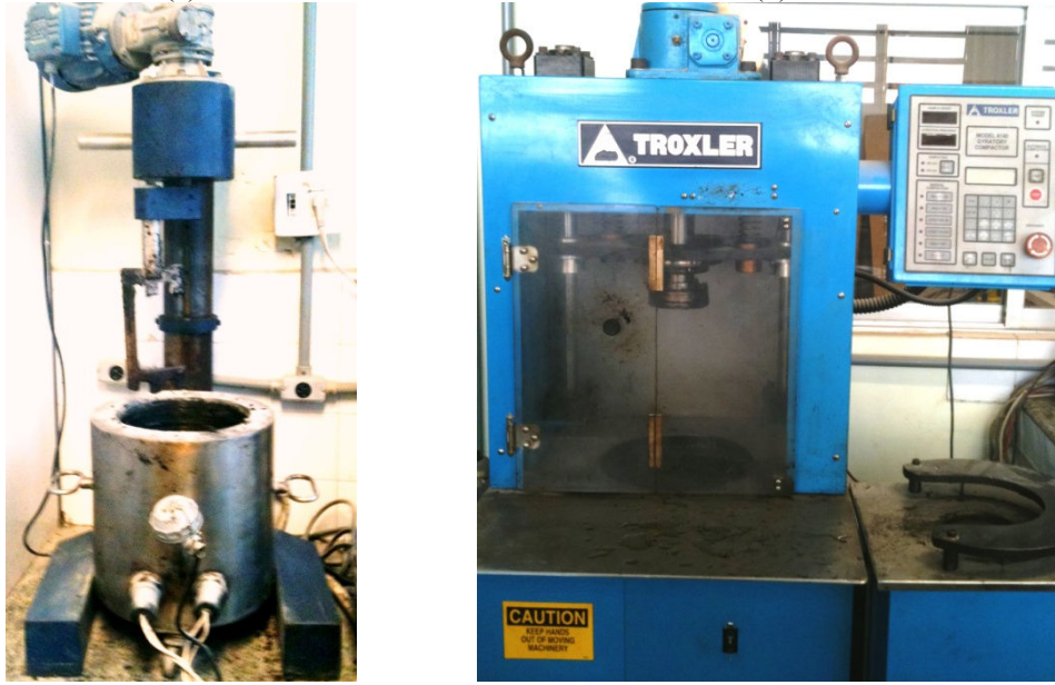
Figura 3.4 – (a) Misturador de escala laboratorial; (b) Compactador Giratório Superpave (CGS)
