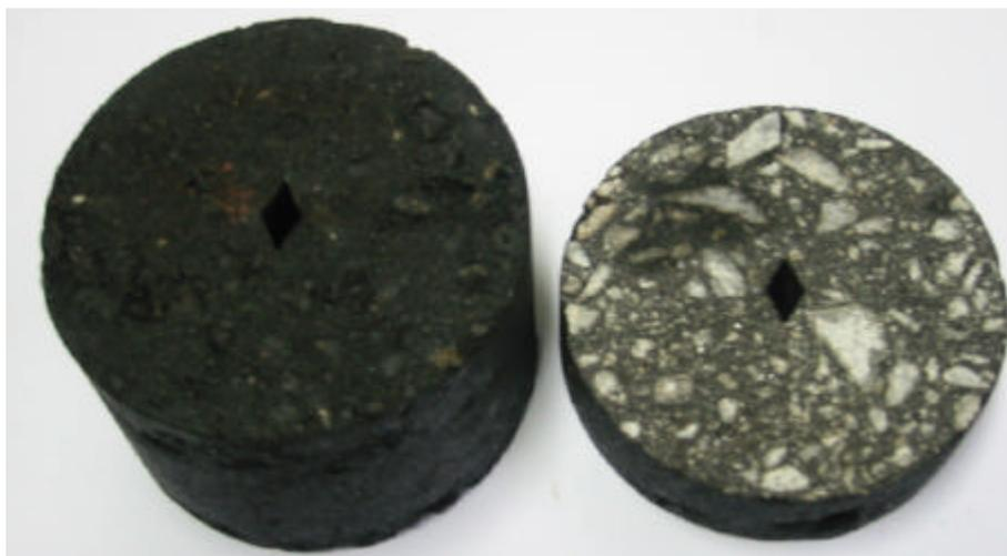
**Figura 3.2:** Corpo de prova de mistura asfáltica tipo CBUQ pré-trincado
