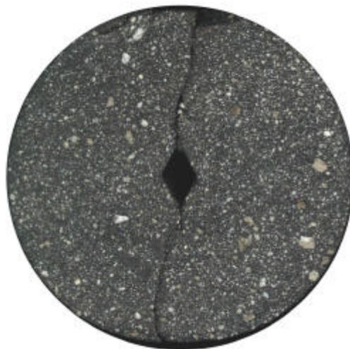
**Figura 4.10:** Trinca formada na mistura de AAUQ após a realização do ensaio de deformação controlada a 0°C na mistura pré-trincada
