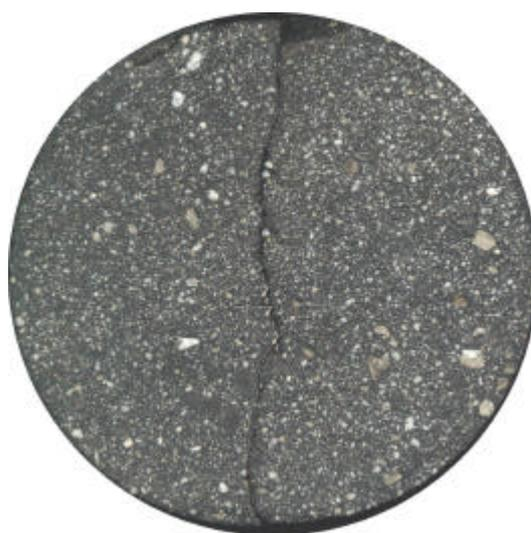
**Figura 4.6:** Trinca formada na mistura de AAUQ após a realização do ensaio de deformação controlada a 0°C
