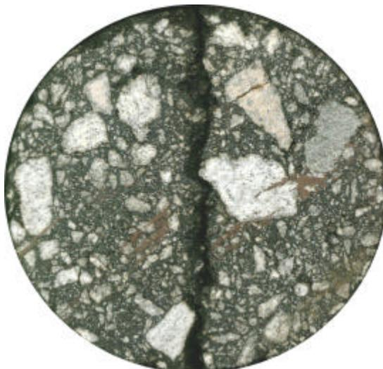
**Figura 4.38:** Corpo de prova de CBUQ após o ensaio de deformação controlada em compressão diametral a 25°C
