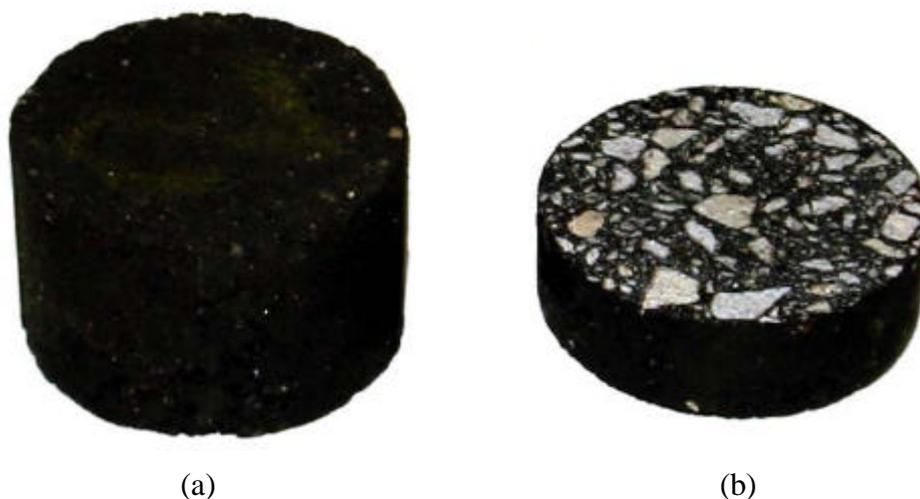
**Figura 3.1:** Corpo de prova de mistura asfáltica tipo CBUQ; (a) corpo de prova padrão (10 cm de diâmetro por 6,3 cm de altura); (b) seção transversal do corpo de prova
