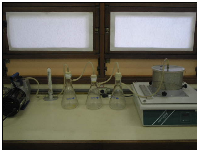
Figura 4. 7: Processo de agitação mecânica e aplicação de vácuo.
