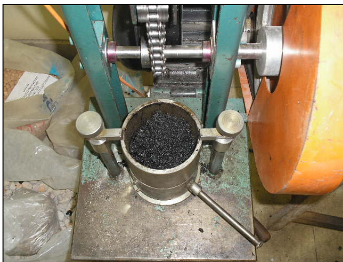
Figura 4. 2: Mistura solta no molde.
