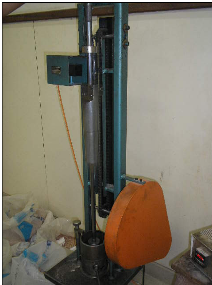
Figura 4. 3: Processo de compactação por impacto (75 golpes).
