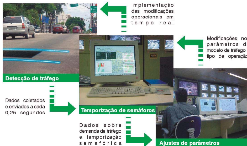
Figura 3.2: Funcionamento do sub-sistema SCOOT de controle semafórico do CTAFOR
