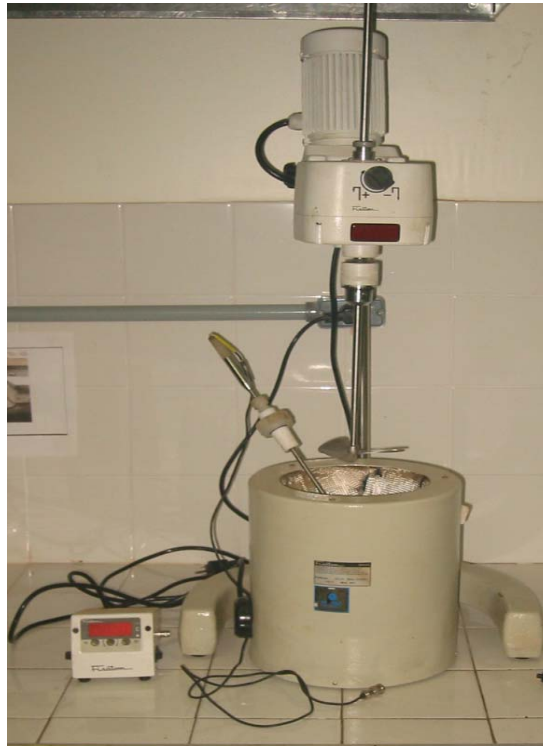
Figura 3.3. Misturador para modificação de ligantes asfálticos em laboratório.
