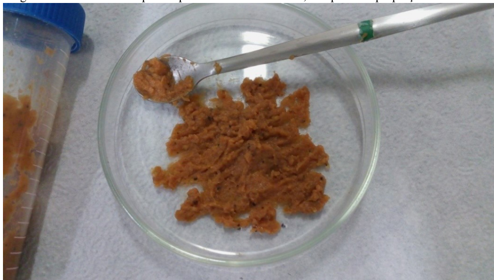
Figura 2. Pasta do resíduo padrão para uso nos biorreatores, composto na proporção da Tabela 3.
