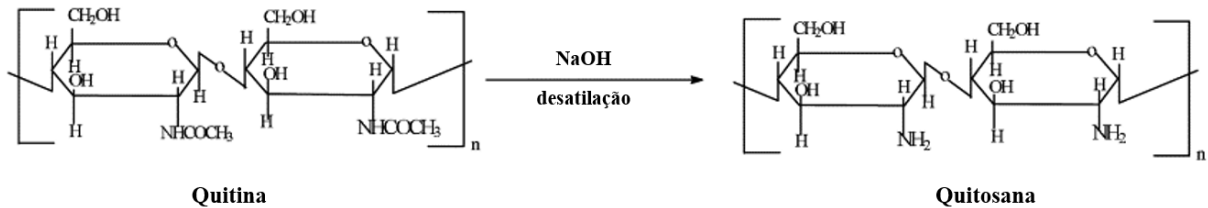
Figura 7 – Processo de obtenção de quitosana pela desacetilação da quitina.
