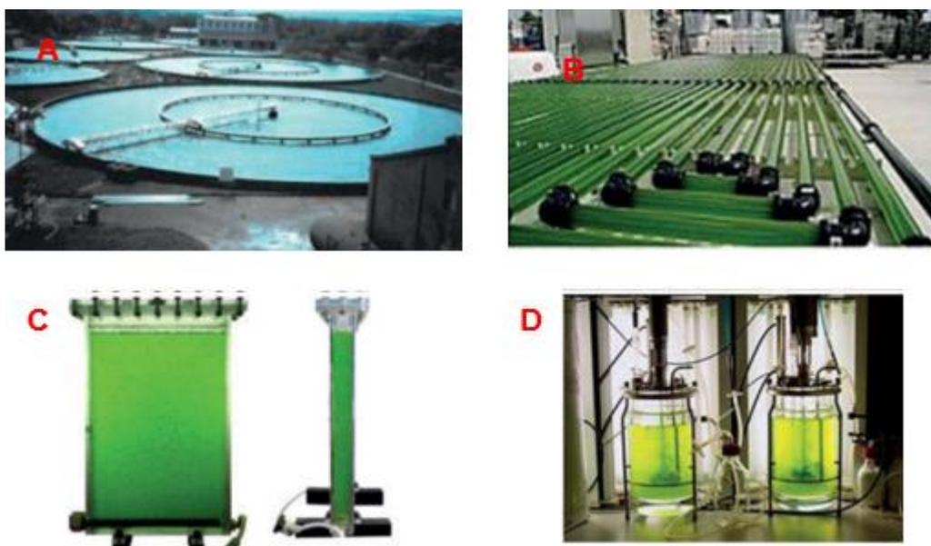
Em A: tanque de cultivo aberto do tipo *Raceway Pond*. Em B, C, D temos fotobiorreatores de diferentes conformações: B - biorreator fechado do tipo tubular; C - biorreator fechado de placas; D - biorreator fechado tubular e em E - biorreator fechado de tanque agitado. Fonte: adaptado de Enzing *et al* 2014
