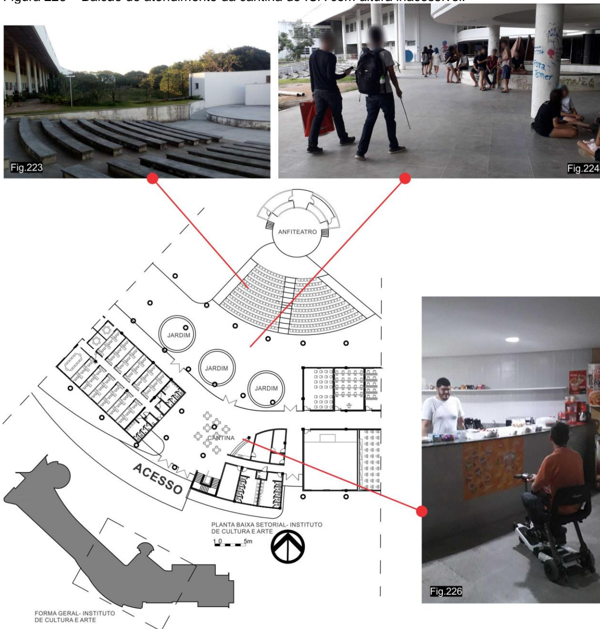
Figura 226 – Balcão de atendimento da cantina do ICA com altura inacessível.
