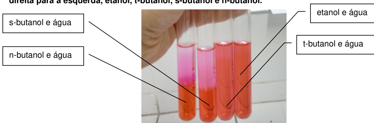
Figura 6. Teste de miscibilidade em água com corante alimentício vermelho, da direita para a esquerda, etanol, t-butanol, s-butanol e n-butanol.
