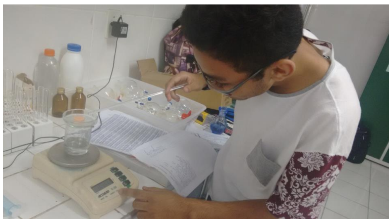
Figura 1: Aluno pesando a massa inicial do sistema: béquer, água e comprimido efervescente.
