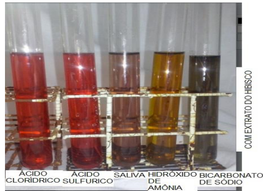
Figura 7: Indicador natural de ácido-base a partir da extração dos pigmentos da flor Hibiscus rosa-sinensis .
