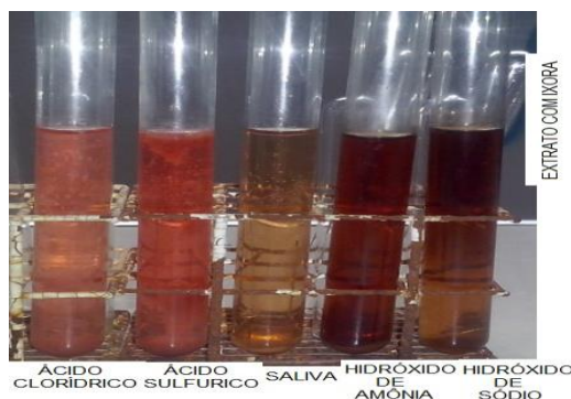
Figura 6: Indicador natural de ácido-base a partir da extração do pigmento da flor Ixora chinensis .
