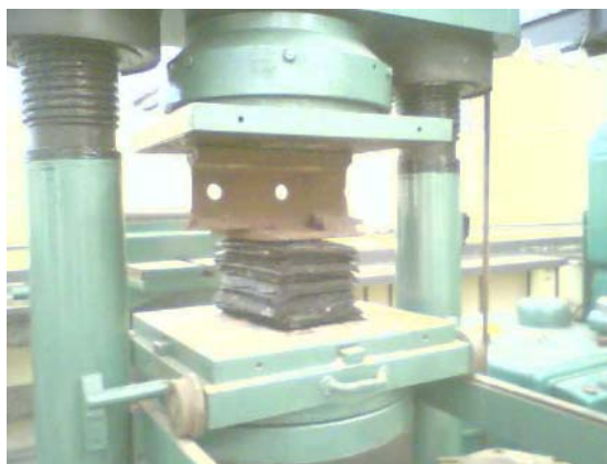
Figura 2.9: Laminas de Borracha sob Carregamento (BONENTE et al. , 2006)
