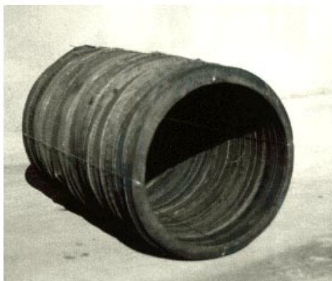
Figura 2.10: Tubos de Drenagem de Águas Pluviais (ODA, 2003)
