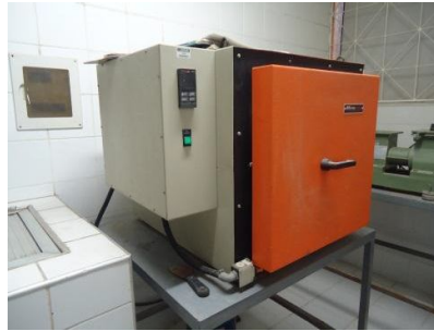
Figuras 18 e 19: Moinho de facas utilizado na preparação da massa a ser moldada na confecção dos corpos de prova e forno utilizado para queima dos corpos de prova.
