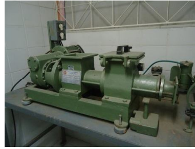
Figuras 15 e 16: Estufa usada nos testes de retração linear e absorção de água e mini-extrusora utilizada para confecção de corpo de prova.
