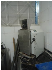
Figuras 18 e 19: Moinho de facas utilizado na preparação da massa a ser moldada na confecção dos corpos de prova e forno utilizado para queima dos corpos de prova.
