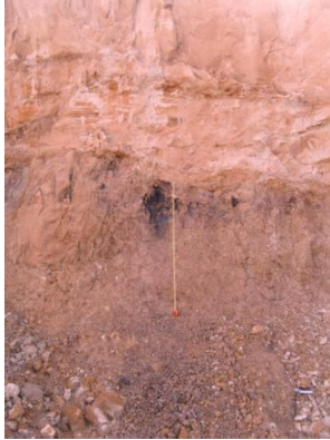
Figura 9 e 10 – Estratificação da área 2 com a presença de material arenoso mais claro na camada superior e de argilito com tonalidade marrom chocolate no sub-estrato inferior. Como referência de escala, trena de 2 metros.
