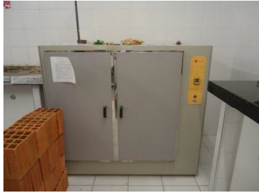
Figuras 15 e 16: Estufa usada nos testes de retração linear e absorção de água e mini-extrusora utilizada para confecção de corpo de prova.
