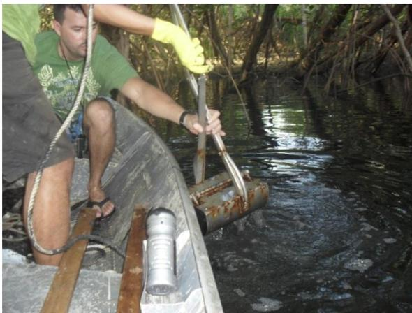
Figura 20 – Coleta de sedimentos com draga de Van Veen (Julho de 2011).
