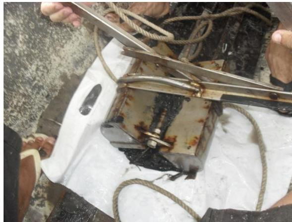
Figura 21 – Abertura da draga com sedimentos (Julho de 2011).
