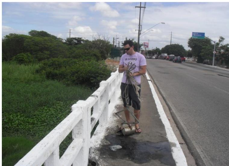
Figura 22 – Coleta de sedimentos na estação 02 sobre a ponte da Avenida General Murilo Borges (julho de 2011).
