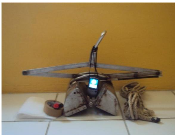
Figura 11 – Draga de Van Veen, GPS e sacos Plásticos para acondicionamento de sedimentos (Julho de 2011).
