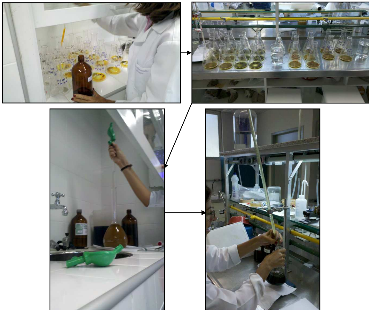
Figura 14: Mosaico de fotografias caracterizando o uso dos equipamentos utilizados no processo de obtenção do teor de matéria orgânica, onde as amostras são colocadas em erlenmeyer para serem analisadas no laboratório.
