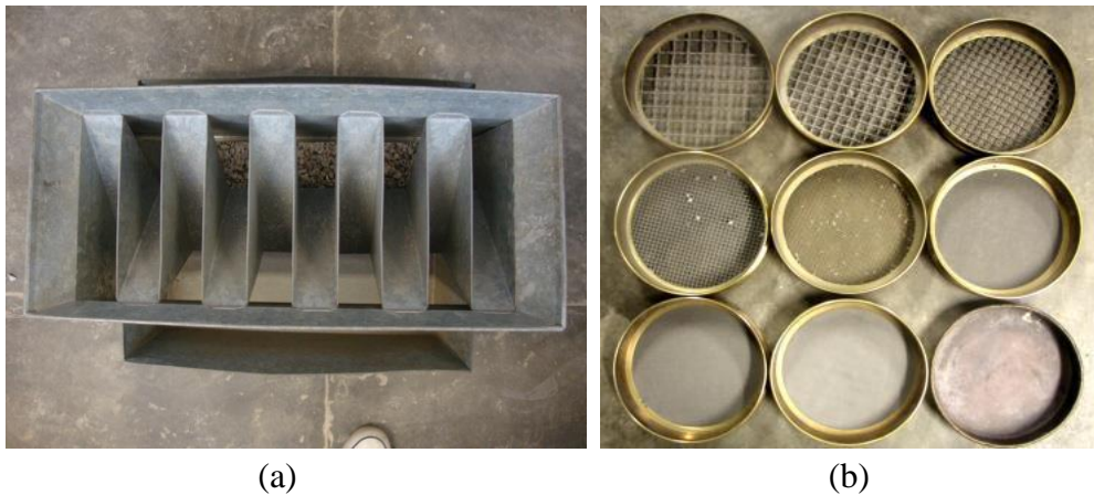
Figura 9 - Ensaio de granulometria: (a) quarteador e (b) conjunto de peneiras
