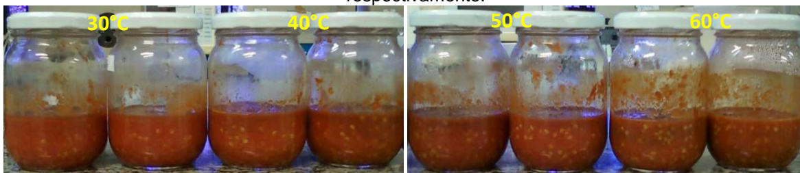
Figura 41 - Polpas de pimenta maceradas enzimaticamente, em duplicata, a 30, 40, 50 e 60°C, respectivamente.
