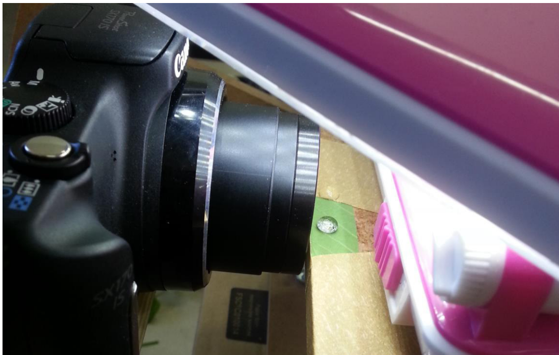
Figura 3 – Captura do perfil horizontal da gota séssil de água destilada, alocada entre as nervuras da face abaxial, de uma folha fixada com fita adesiva.
