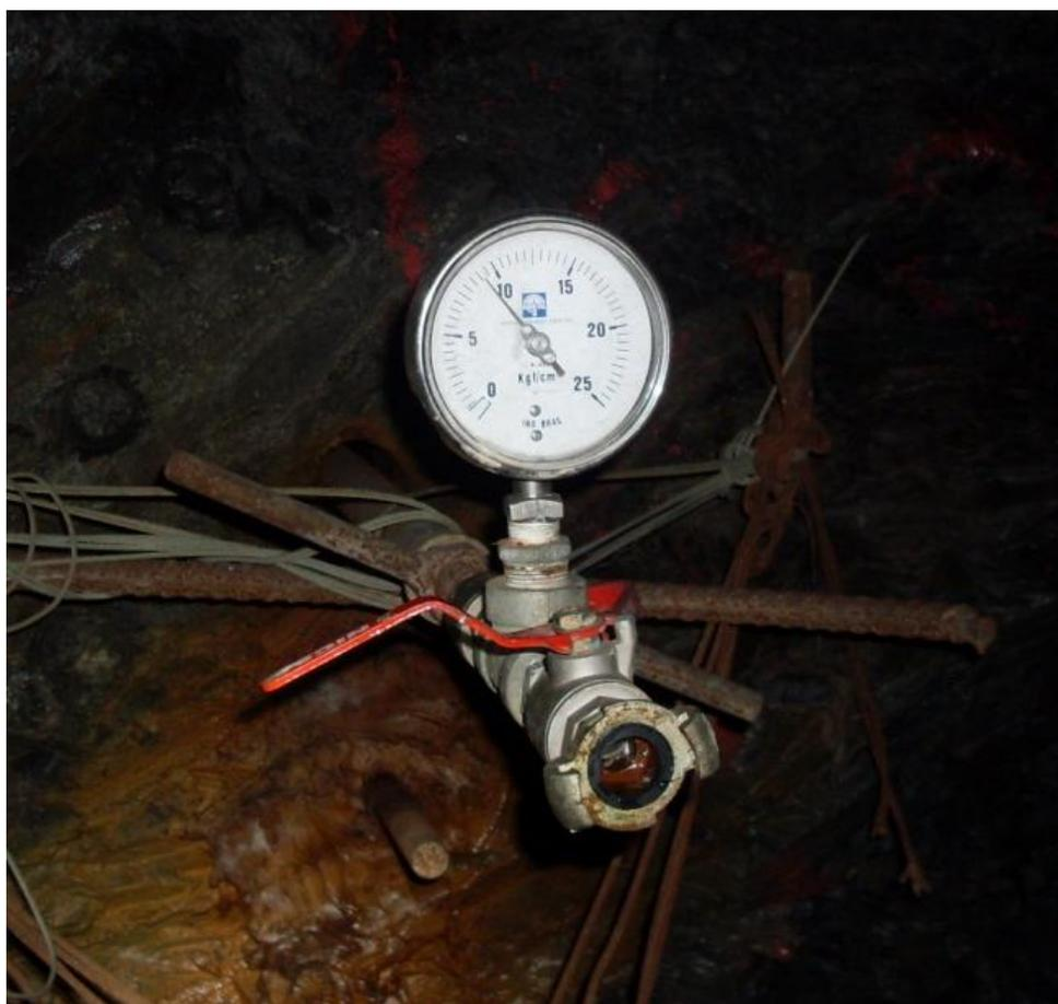
Figura 4.5 - Manômetro instalado em um furo de sondagem obturado – Fev/2011
