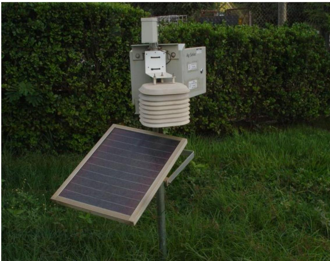
Figura 4.2 - Estação pluviométrica
