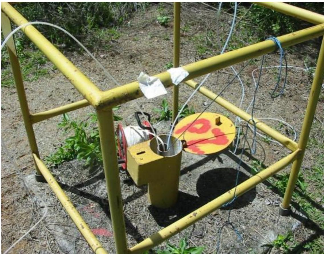
Figura 4.6 - Coleta de água subterrânea pelo método Low Flow (Baixa Vazão) – Fev/2011
