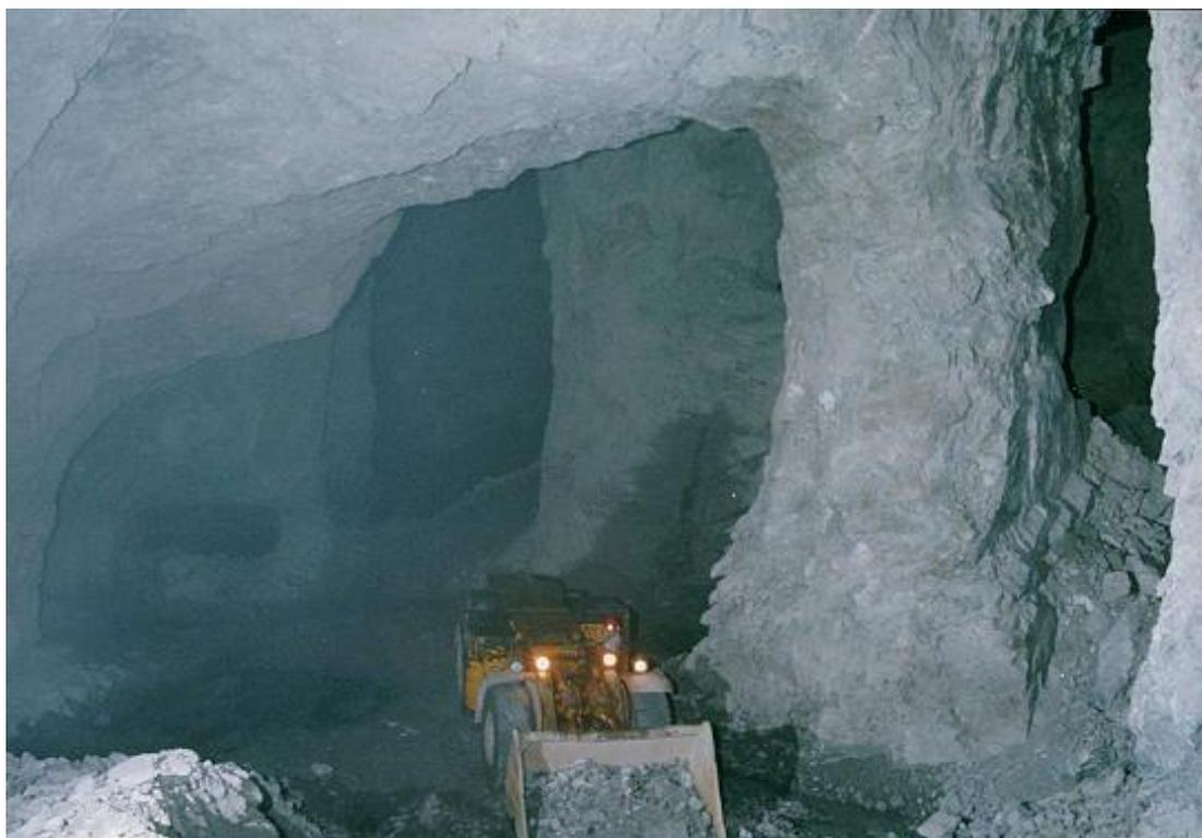
Figura 2.4 - Foto do método de lavra da Mina de Morro Agudo (câmaras e pilares)
