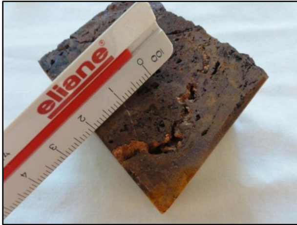
Figura 46 - Estrutura de lixiviação, possível notar a presença de “canais”, “tubos” e “vazios”, oriundos da subtração de matéria.
