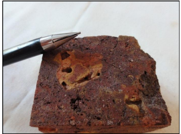
Figura 54 - Estruturas de lixiviação.
