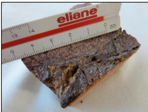
Figura 19 - Estruturas de lixiviação, possível observar “vazios” gerados pela remoção do material.
