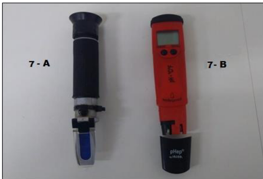
Figura 7. (A) Refratômetro da marca Sibaolu; (B) pHmetro da marca Hanna.
