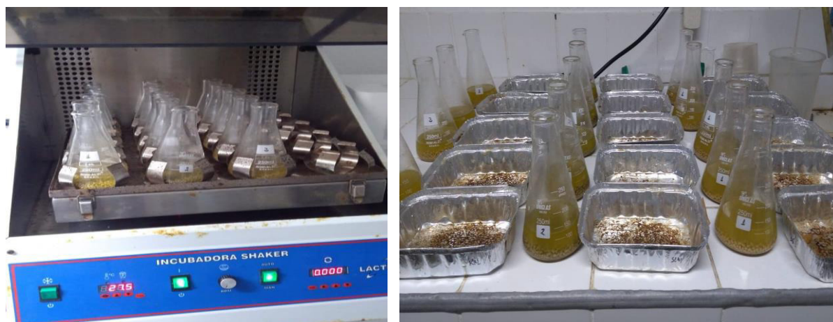
Figura 6- Agitador orbital (Incubadora Lac-INR-1000®, Látcea, São Paulo) e Amostras antes de serem drenadas para posterior secagem.
