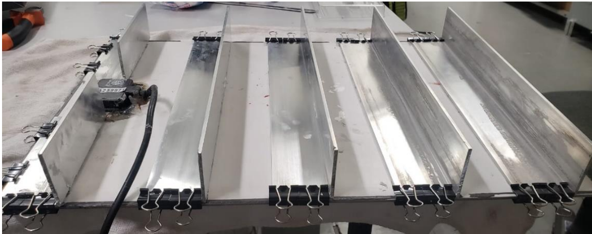
Figura 4.1 – Disposição das aletas de alumínio na parte posterior do módulo FV
