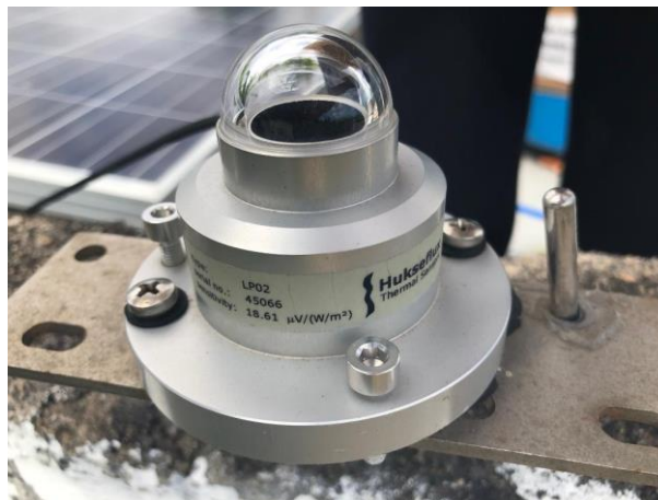
Figura 4.5 – Piranômetro modelo LP02
