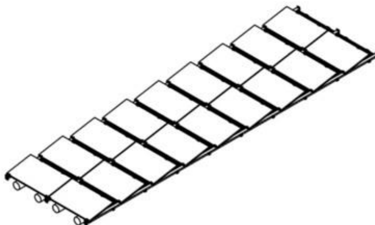
Figura 2.9 – Constituintes básicos de um flutuador do tipo pontão com 18 módulos FV
