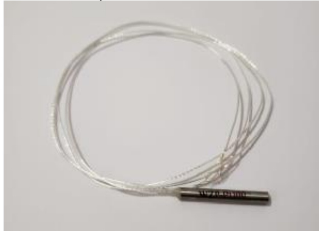
Figura 4.4 – Sensor de temperatura PT100
