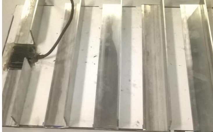
Figura 5.1 – Superfície posterior de módulo FV KS20T com pontes de calor
