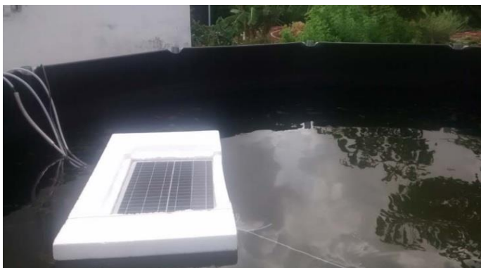
Figura 2.10 – Módulo de 20 Wp policristalino flutuante em estrutura de isopor
