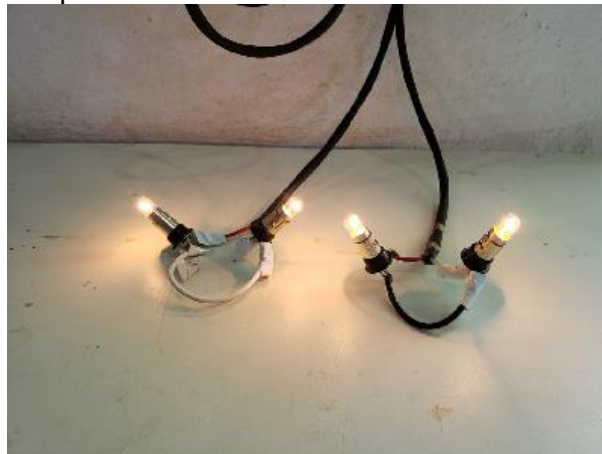
Figura 4.9 – Lâmpadas conectadas aos terminais de saída do módulo FV
