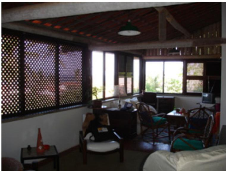
Fig. 30: Foto interna da Casa da Prainha, onde é possível visualizar a madeira (carnaúba) utilizada como estrutura, 2012
