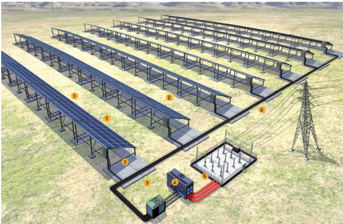
Figura 3.21: Instalação típica de um Parque Solar Fotovoltaico.
