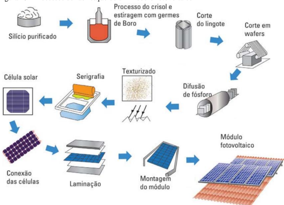
Figura 13 - Processos de fabricação de um módulo fotovoltaico
