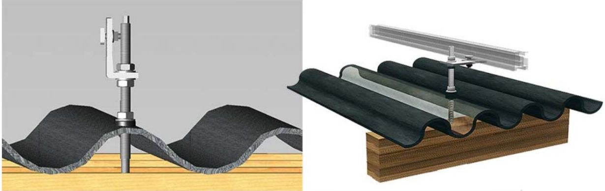
Figura 16 - Fixação do suporte para painéis em telhas de fibrocimento
