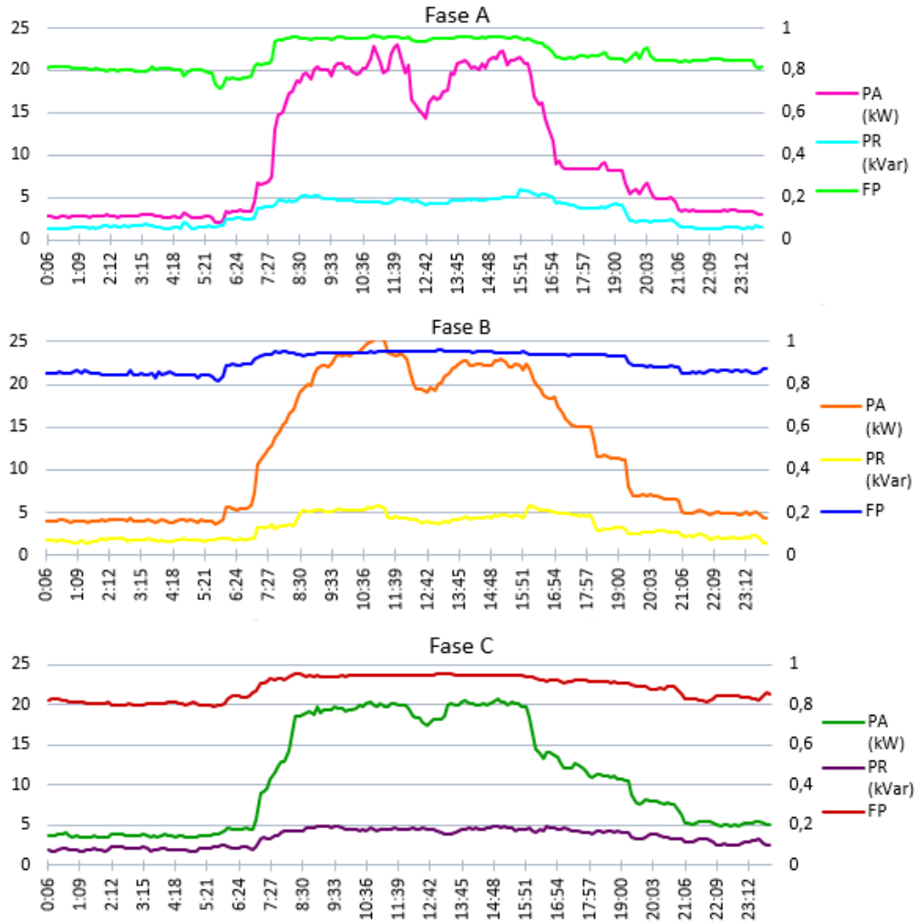
Figura 44 – Potência ativa (PA), reativa (PR) e fator de potência (FP) do quadro de iluminação.
