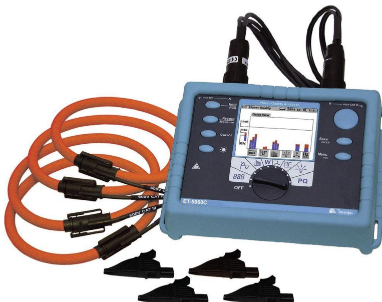
Figura 5.1 - Design analisador de QEE, Minipa et 5060c.
